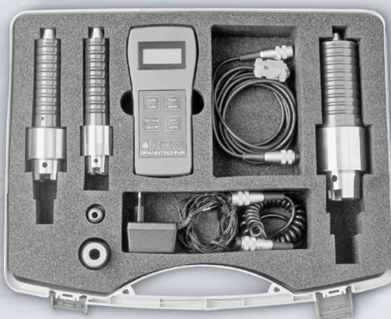
Das BERG-Spannkraftmesssystem für die Werkzeugaufnahme ist zur Kraftmessung bei stehender Spindel bestimmt!
